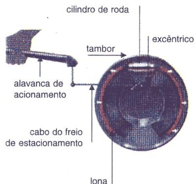
esquema de um freio de estacionamento
