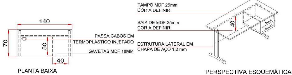
8.7. Deverão ser confeccionados em MDF espessura mínima de 25mm, com revestimento melamínico texturizado de Alta Pressão (AP) em ambas as faces, acabamento das bordas em fita ABS 3mm colados ao substrato de madeira pelo processo “hot melt” e cor da definir após a contratação.
