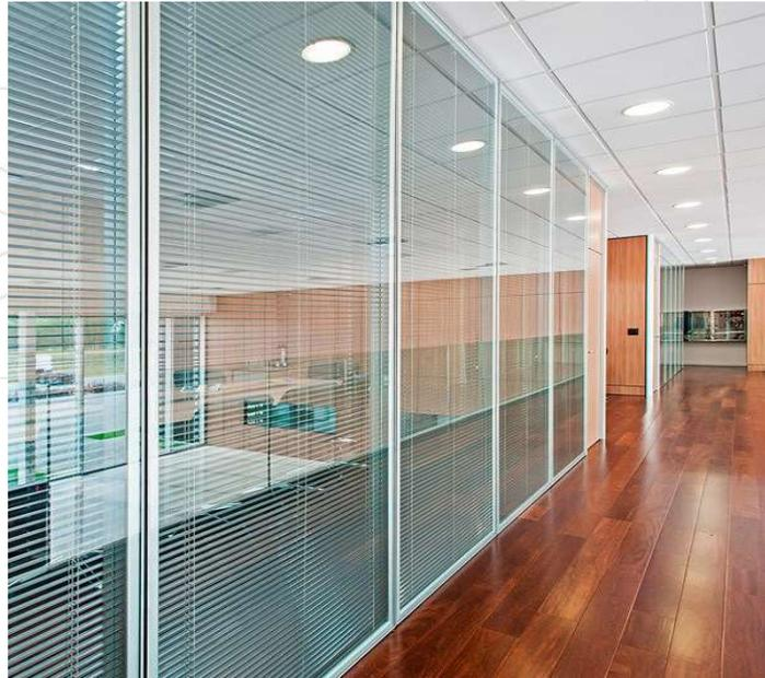
5.3.2. Parede *drywall* acústica, constituída por estrutura de perfis de aço galvanizado na qual são parafusadas, em ambos os lados, placas de gesso cartonado e lã mineral no interior.
