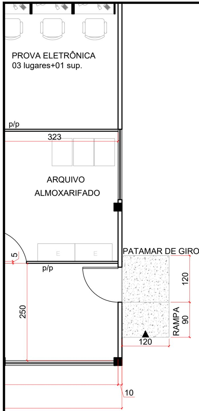
RAMPA COM INCLINAÇÃO DE 8,88°, E ELEVAÇÃO DE GIRO DE 8 CM, OU ATÉ A ALTURA DA SOLEIRA
