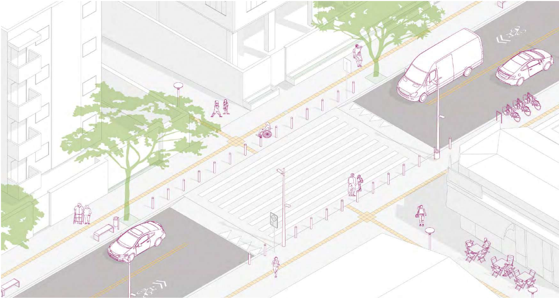
Figura 8 - Platô implantado em via bidirecional de 30 km/h com presença de ciclorrota em área de uso misto.
