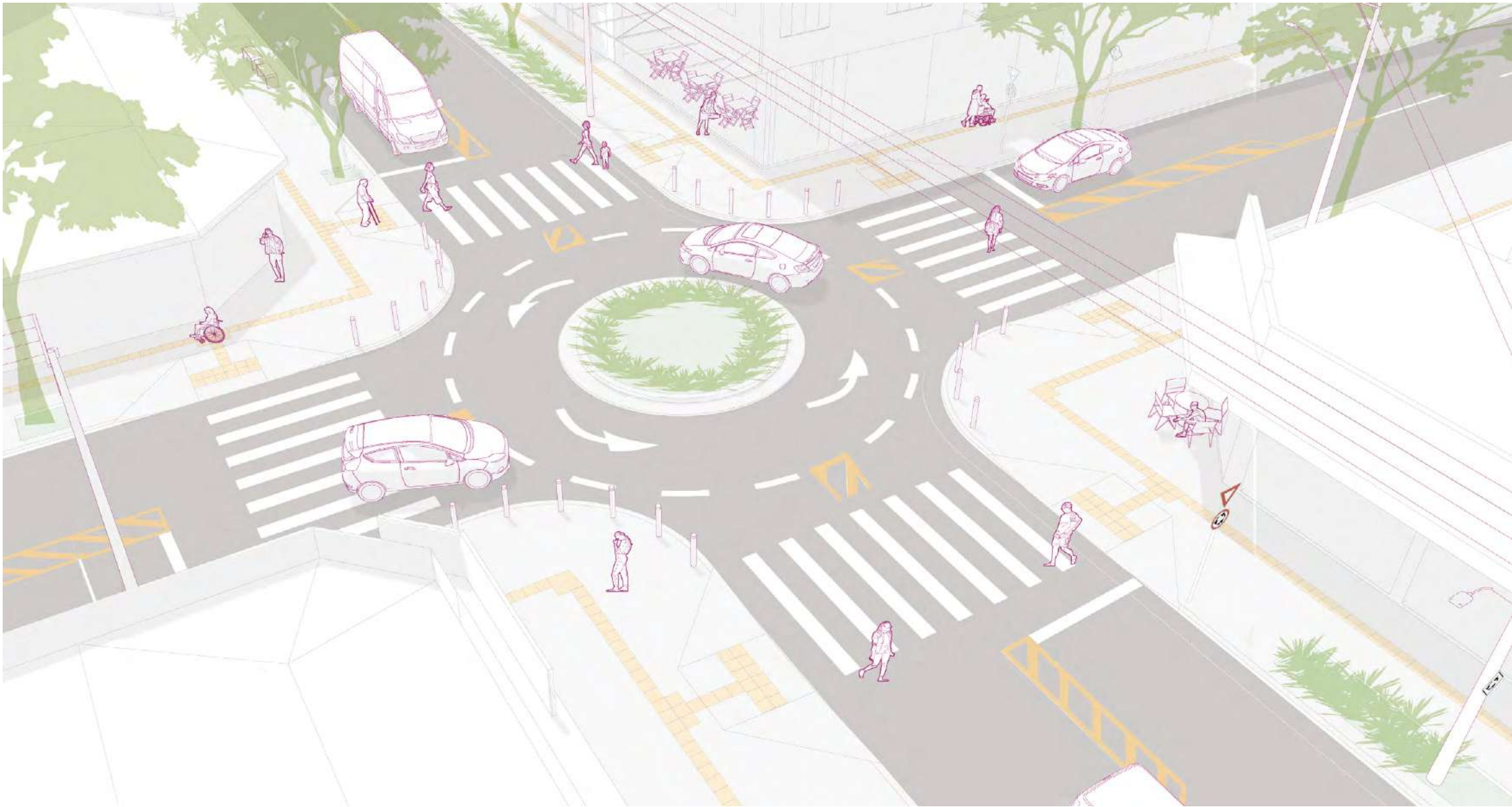
Figura 22 - Minirrotatória implantada em interseção de vias bidirecionais em área de uso misto.
