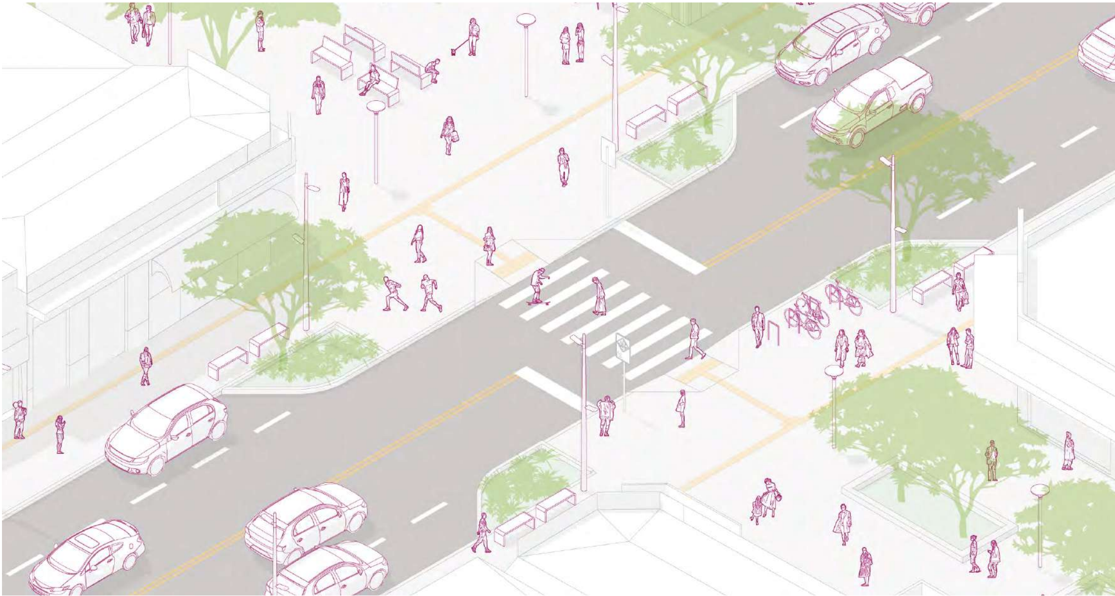
Figura 28 - Estreitamento em meio de quadra implantado em via coletora bidirecional em área predominantemente comercial e de lazer.
