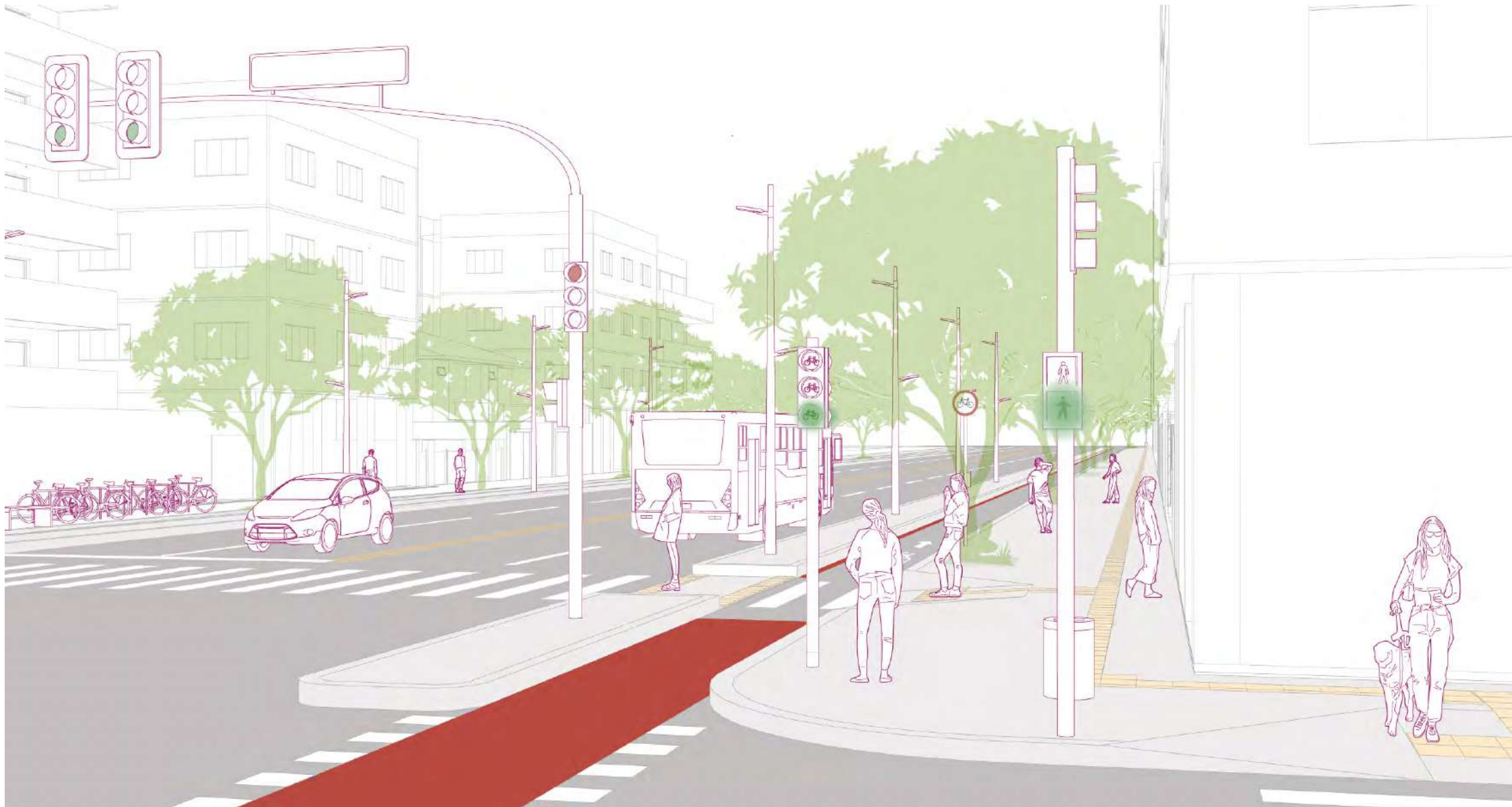
Figura 42 - Semaforização para pedestres e ciclistas em interseção de via arterial bidirecional com ciclovia e grande circulação de pedestres.
