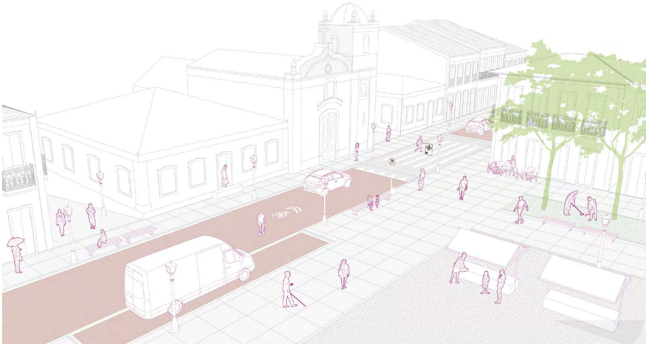
Figura 33 - Texturização e pavimento colorido implantados em conjunto com platô, em via local unidirecional, localizada em área central com existência de polos geradores de tráfego.
