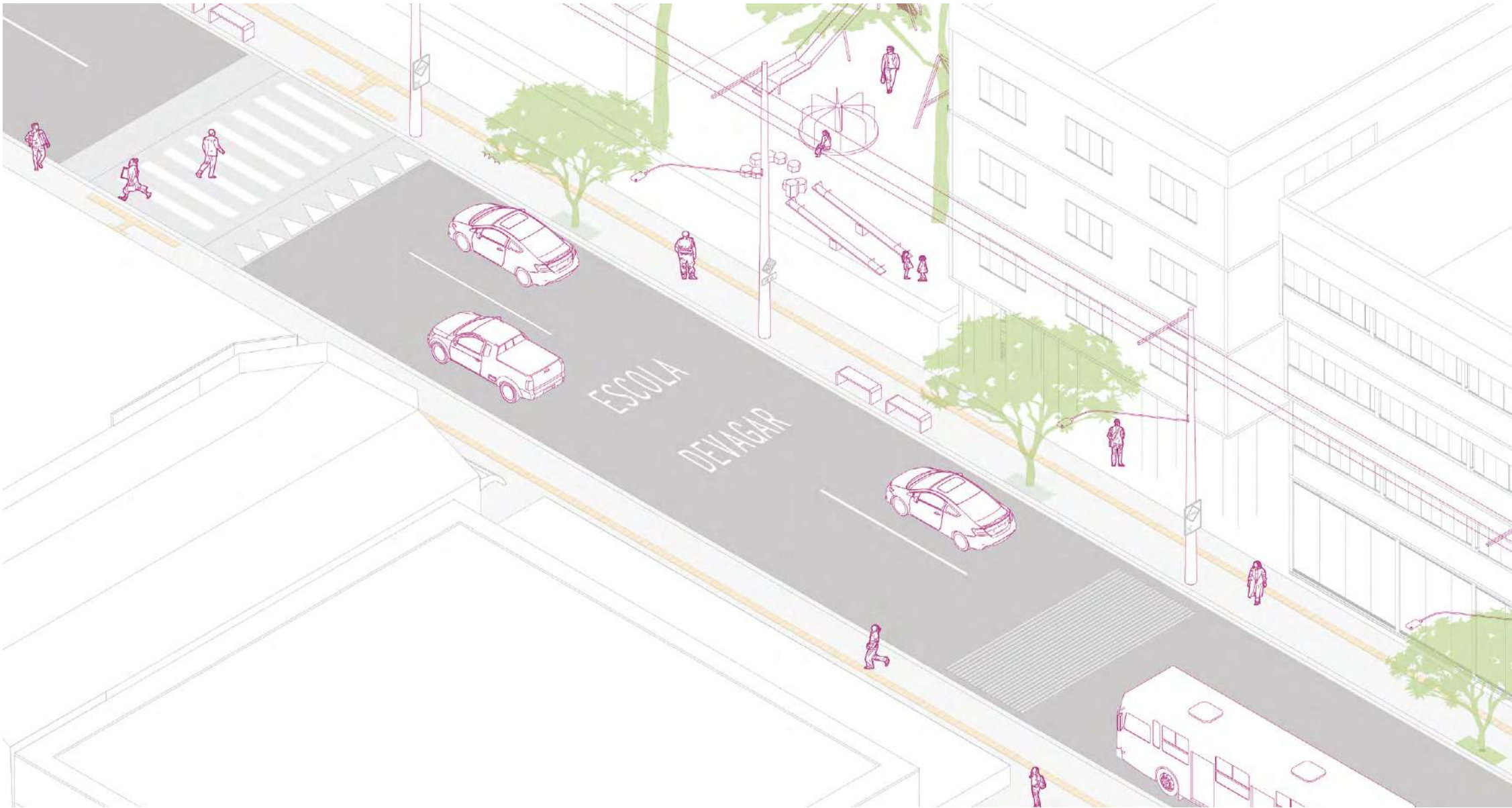
Figura 34 - Sonorizadores implantados em via coletora unidirecional localizada em área escolar.
