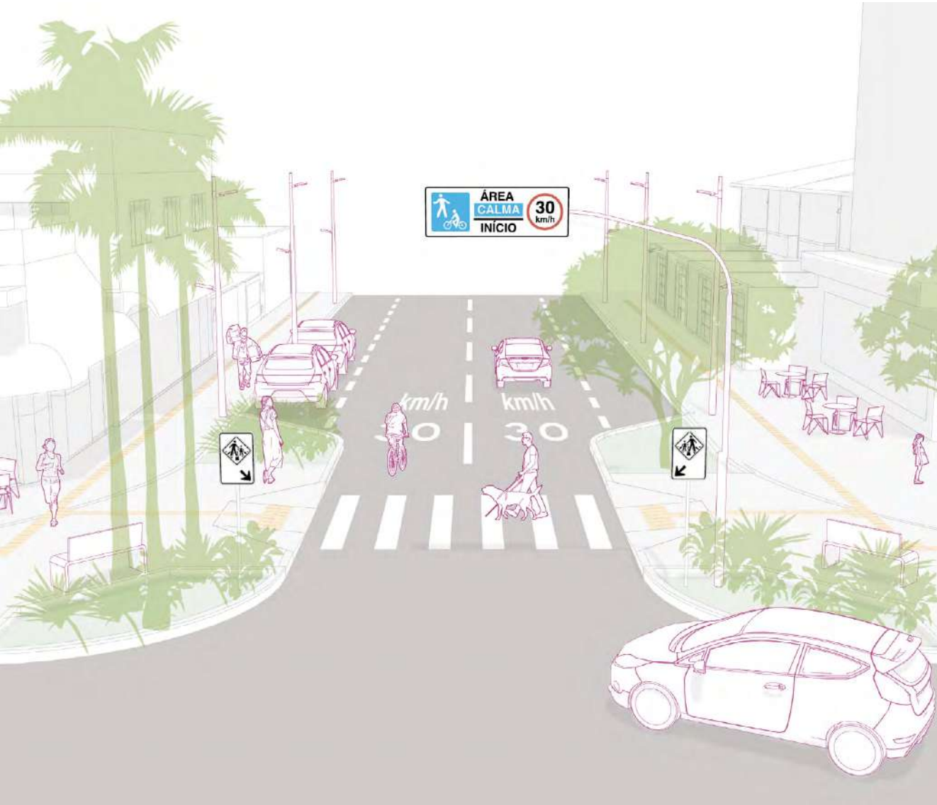
Figura 36 - Sinalização horizontal e vertical indicando o início e o limite de velocidade em uma área de trânsito calmo.
