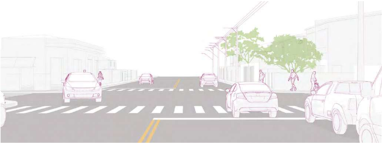
Figura 14 - Situação antes: Via bidirecional com faixas de trânsito largas sem extensões de meio-fio e sem estacionamento em área de uso misto.
