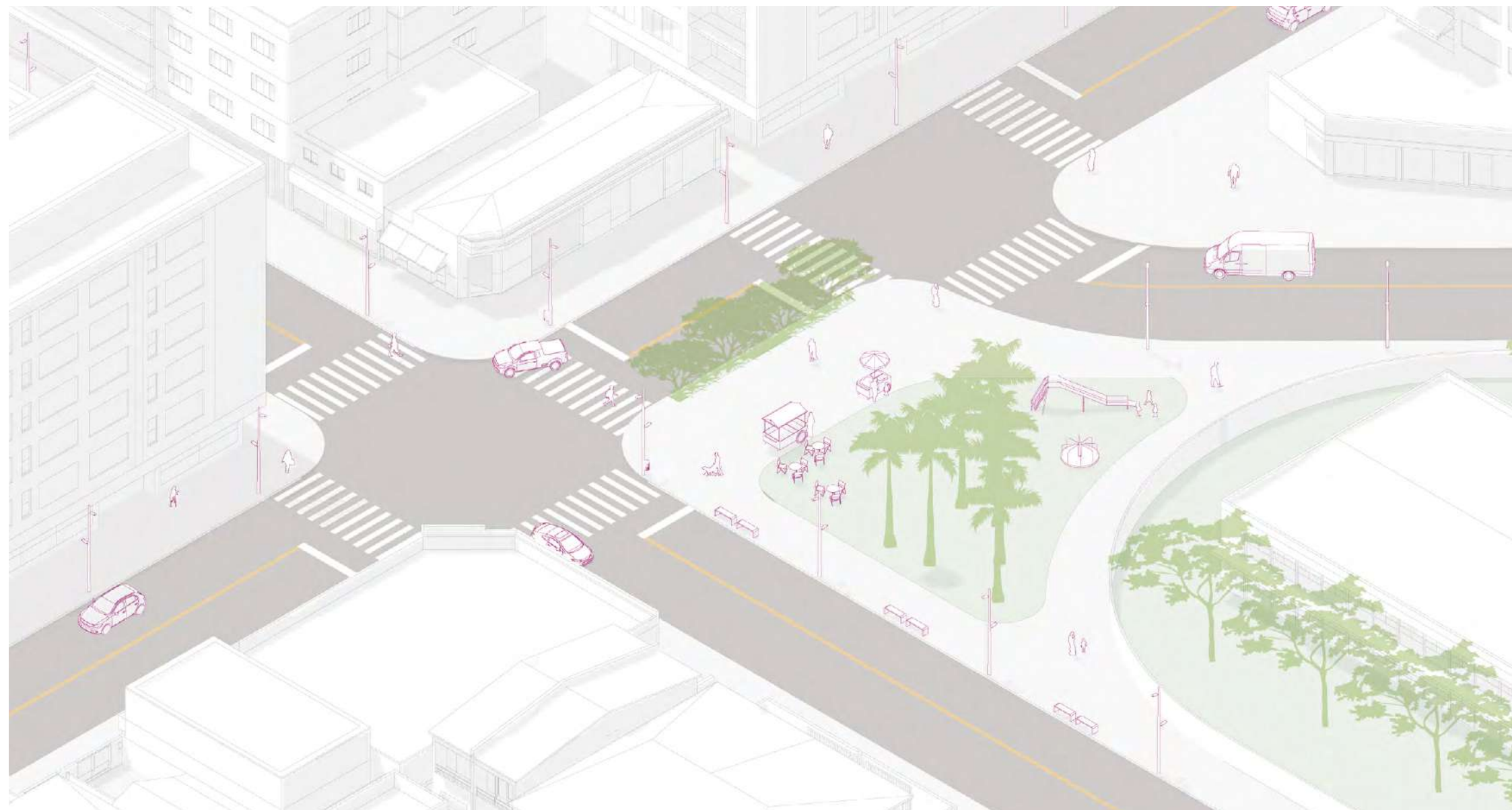
Figura 13 - Situação depois: Extensão de meio-fio implantada para melhor ajuste de alinhamento em interseção.
