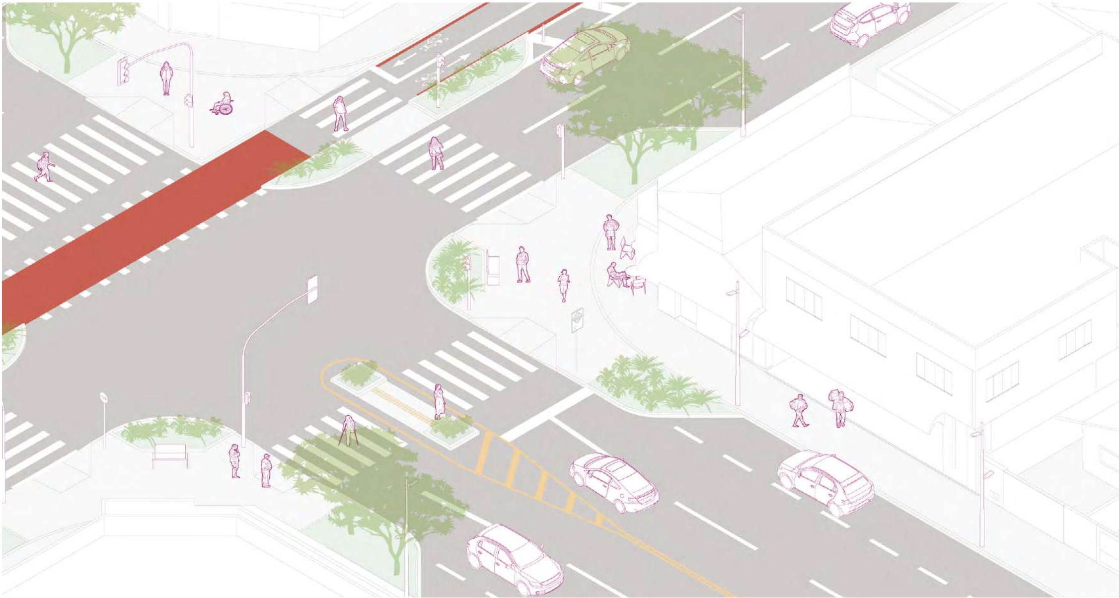
Figura 11 - Extensões de meio-fio implantadas com mobiliário urbano e paisagismo em uma interseção entre via coletora e arterial com presença de ciclovia bidirecional em área de uso misto.
