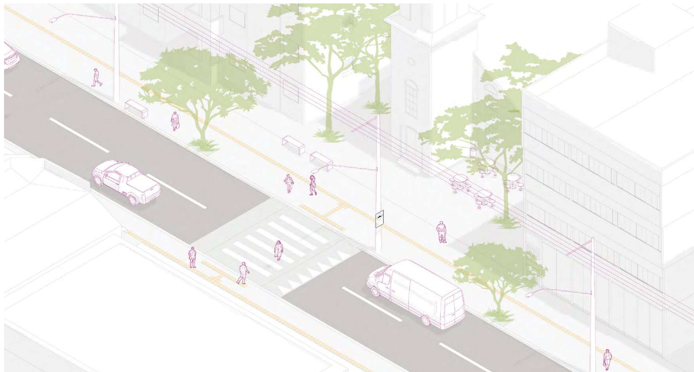
Figura 7 - Faixa elevada para travessia de pedestres implantada em via coletora unidirecional em área de uso misto.
