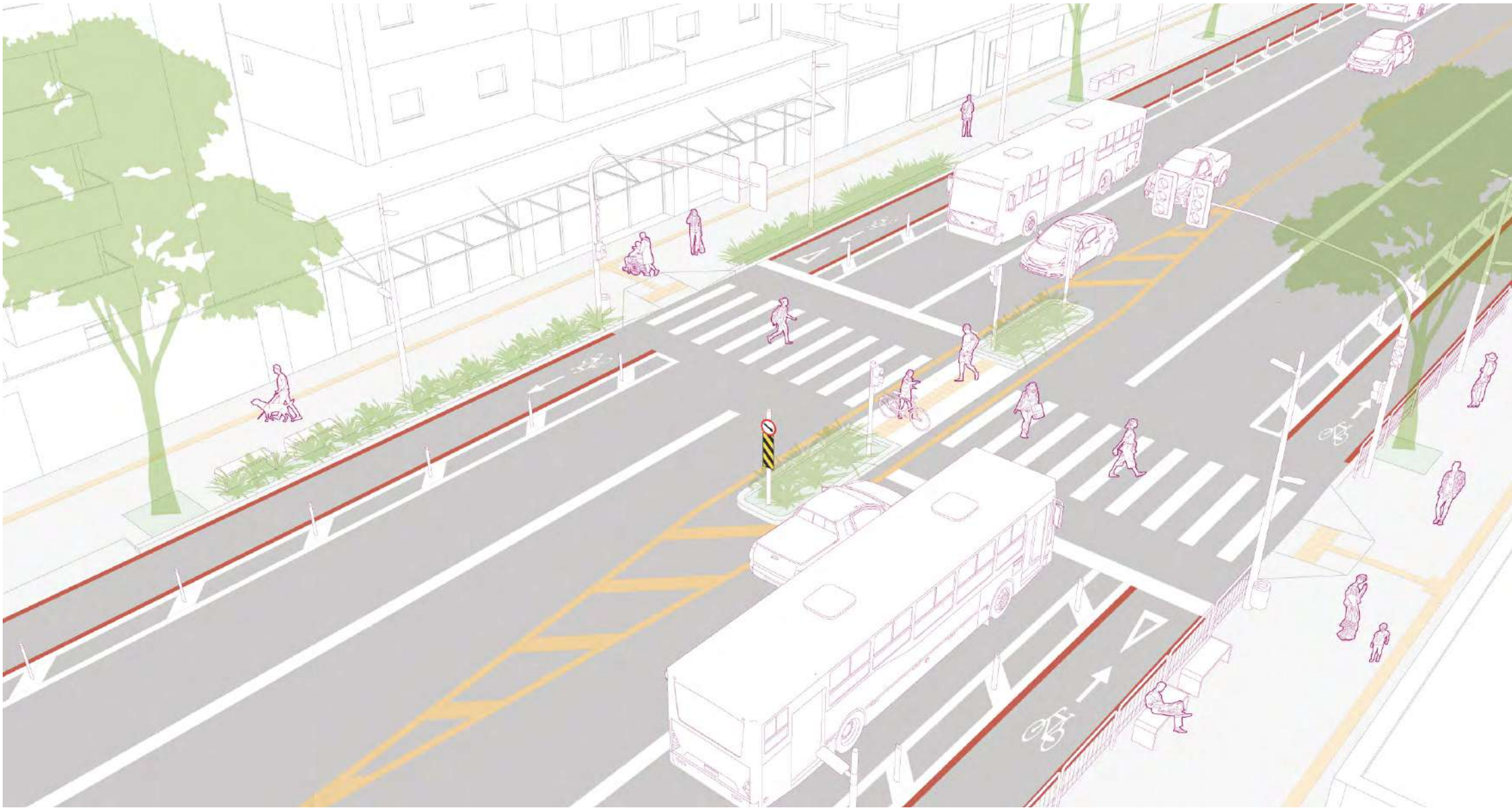
Figura 31 - Ilha de refúgio para pedestres implantada em via arterial bidirecional com presença de ciclovia unidirecional em cada bordo e faixa exclusiva para transporte coletivo.
