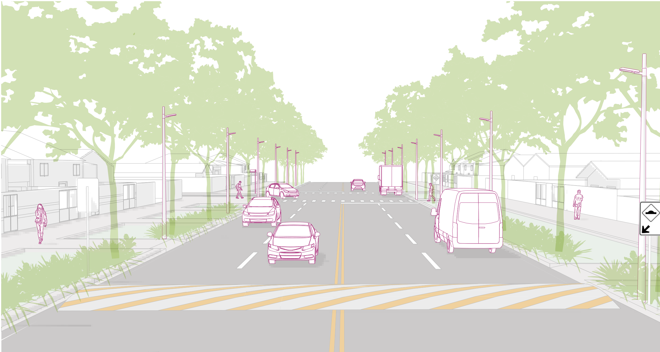
Figura 39 - Estreitamento visual criado a partir da implantação de elementos verticais em via arterial bidirecional.
