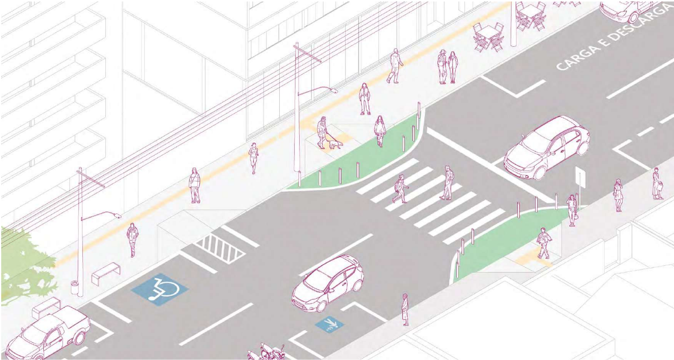
Figura 41 - Estacionamento implantado em ambos os lados da via em conjunto com extensões de meio-fio (utilizando elementos de urbanismo tático) em via coletora unidirecional.
